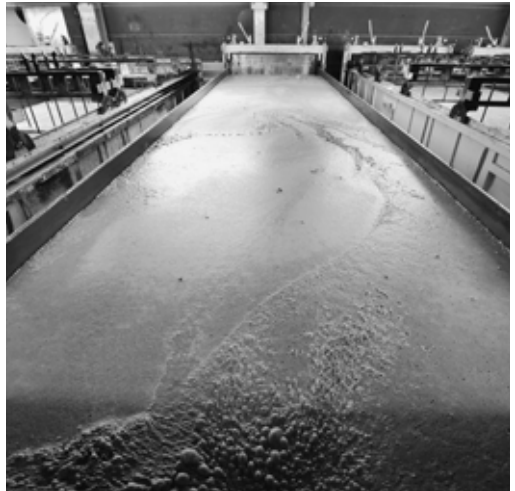
Fertig befüllte Gießform zu Beginn des Treibvorgangs.
