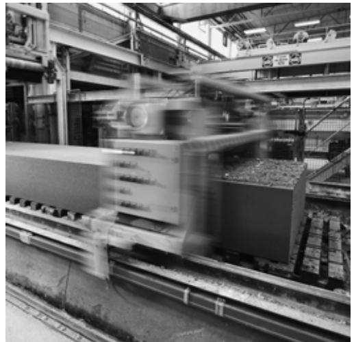
Schneiden und Profilieren der bis zu 8,3 m × 1,5 m × 0,75 m großen Blöcke.
